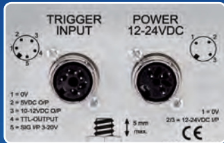
Anschlüsse: links Trigger, rechts Spannungsversorgung
