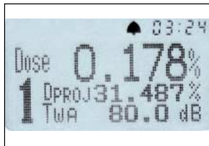
Das LCD Display Übersichtlich wird angezeigt, ob Ihre Ohren gefährdet sind
